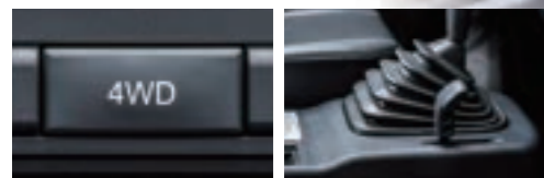
按鍵式切換4WD設計 四輪轉動+加力檔設計
