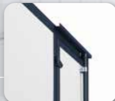
側門導水槽 防止雨水滲入廂內
