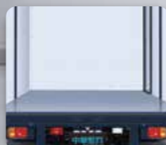
廂底底板 鍍鋅鋼板
