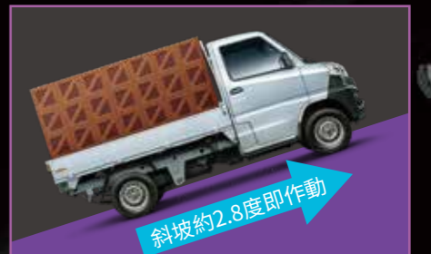
斜坡約2.8度即作動 上坡時放開煞車起步瞬間，車輛不後滑(2秒內)防止意外發生
