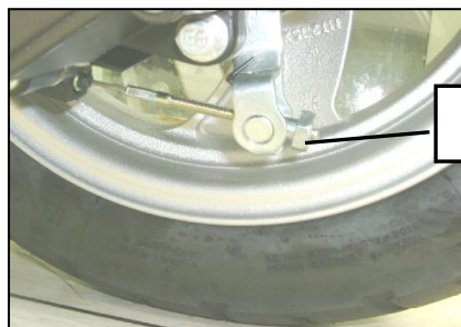
煞車游隙 調整螺帽
